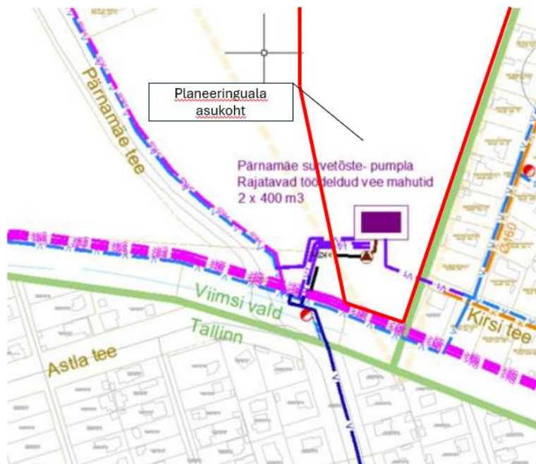
Joonis 6. Väljavõte Viimsi valla ühisveevärgi ja -kanalisatsiooni arendamise kavast 2024-2036. Pärnamäe survetõstepumpla põhimõtteline asukohaskeem
